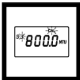
14. 显示屏将显示 S3 图标 ( 3 将闪烁) 和 800NTU 或者是以前校准的 S3 标准液值。
